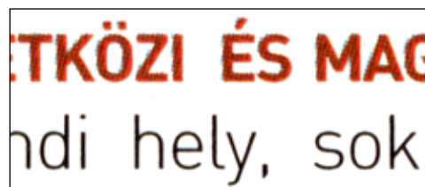
Passzerhiba. A sárga és bíbor szín pontosan együtt áll, a cián viszont egy raszterpontnyival elcsúszott fölfelé és balra – ez mintegy 2 tized milliméteres regiszter pontatlanságot jelent
